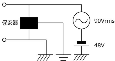
直流電源電圧と呼出信号電圧が重畳する場合の計算方法
