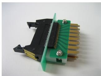
新交換機側の40号ARRに挿入し、新交換機を現用回線から切り離します
