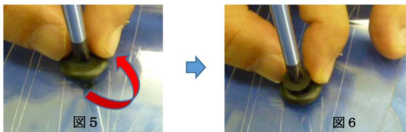
万が一プッシュターナーリベットを取り外す際は、図5のように指で固定し、プラスドライバーをプッシュターナーリベットの+に合わせ図5のように回すと図6のように外れてきます。(無理に外そうとすると破損します)
